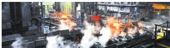
Warmbetrieb an der Stoßbank
